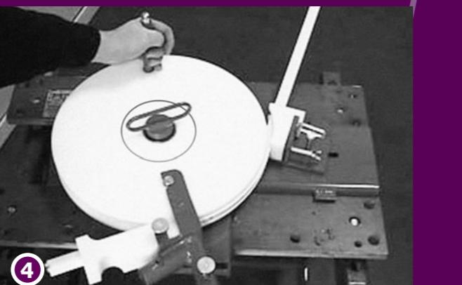
3 Plaats de Keg (C) zoals aangegeven. Meet vanaf de Referentielijn (F) op het buigwiel tot het einde van de rail aan de voorkant van het buigapparaat. Dit creëert de afstand van de voorkant van de rail tot de wand. Draai de schroef van de keg vast (C).
