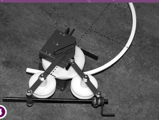
Bug die raillengte tussen de gemarkeerde punten steeds tot het midden van het tweede kleine buigwiel (A). Na elke keer dat de totale lengte door de VARIO-set is gerold, draai een paar keer aan de kleine hendel (E) en meet de afstand tussen de gemarkeerde punten op de rail. Herhaal deze handelingen net zolang totdat de gewenste diameter bereikt is. Te ver gebogen? Plaats de rail in omgekeerde richting in de VARIO-set.
