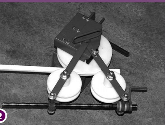
Om de benodigde raillengte te bepalen, bereken  $3,14 \times$  de diameter van de te buigen cirkel, of meet de mal na aan beide uiteinden bij. Plaats de buigstrip in de rail (zoals foto 1 van pagina 1 van deze brochure laat zien) en plaats deze tussen de buigwielen (zie foto). Draai Hendel (E) zodanig, dat er geen speling tussen rail en wielen meer is. Voor een rechtse bocht: T-strip naar boven. Voor een linkse bocht: T-strip naar beneden.
