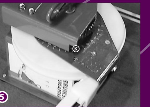
Draai totdat de gewenste hoek bereikt is. Het Graden Referentiepunkt (K) geeft de exacte graden van de bocht aan op de gradenboog. Draai een halve slag meer om terugbuiging van het aluminium in de bocht tegen te gaan.
