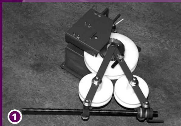
Verwijder van het compact buigapparaat de metalen draagpin en vervang het buigwiel (radius 10 cm) en plaats de VARIO-set in het metalen huis van het compact buigapparaat. Stel de Stabilisator (D) zo in, dat speling tussen de Kleine Buigwielen (A) en het compact buigapparaat voorkomen wordt.
