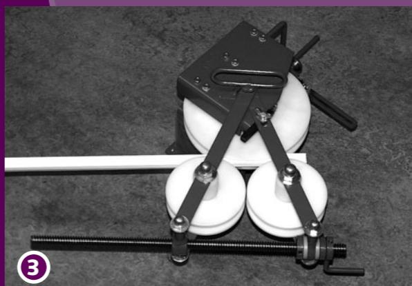
Teken de te buigen afstand af op de rug van de rail. Draai de kleine hendel (E) maximaal 5 keer en draai dan aan de grote hendel van het compact buigapparaat om de rail langs de wielen van de VARIO-set te laten rollen. De wielen moeten meedraaien. Begeleid desnoods de rail met de hand.
