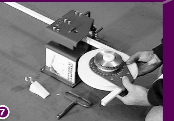
Belangrijk: als de gewenste hoek bereikt is, draai dan de hendel een paar slagen terug zodat je voelt dat de spanning van de hendel af is. Verwijder dan pas de Metalen Draagpin (D) en keg en haal het buigwiel met de rail voorzichtig uit het metalen huis.
