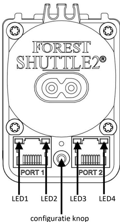
Gebruik een pen of pin om de configuratie knop te bedienen. Kies de instelling die u wilt wijzigen (in de tabel) en druk de knop X maal kort in (overeenkomend met gewenste instelling).
