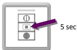
Dans les 10 secondes, sélectionnez un canal et appuyez le bouton Ouvrir :
