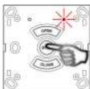
Maintenez la télécommande à max 0,5 mètre distance de la récepteur, choisissez le canal et appuyez le bouton Fermer
