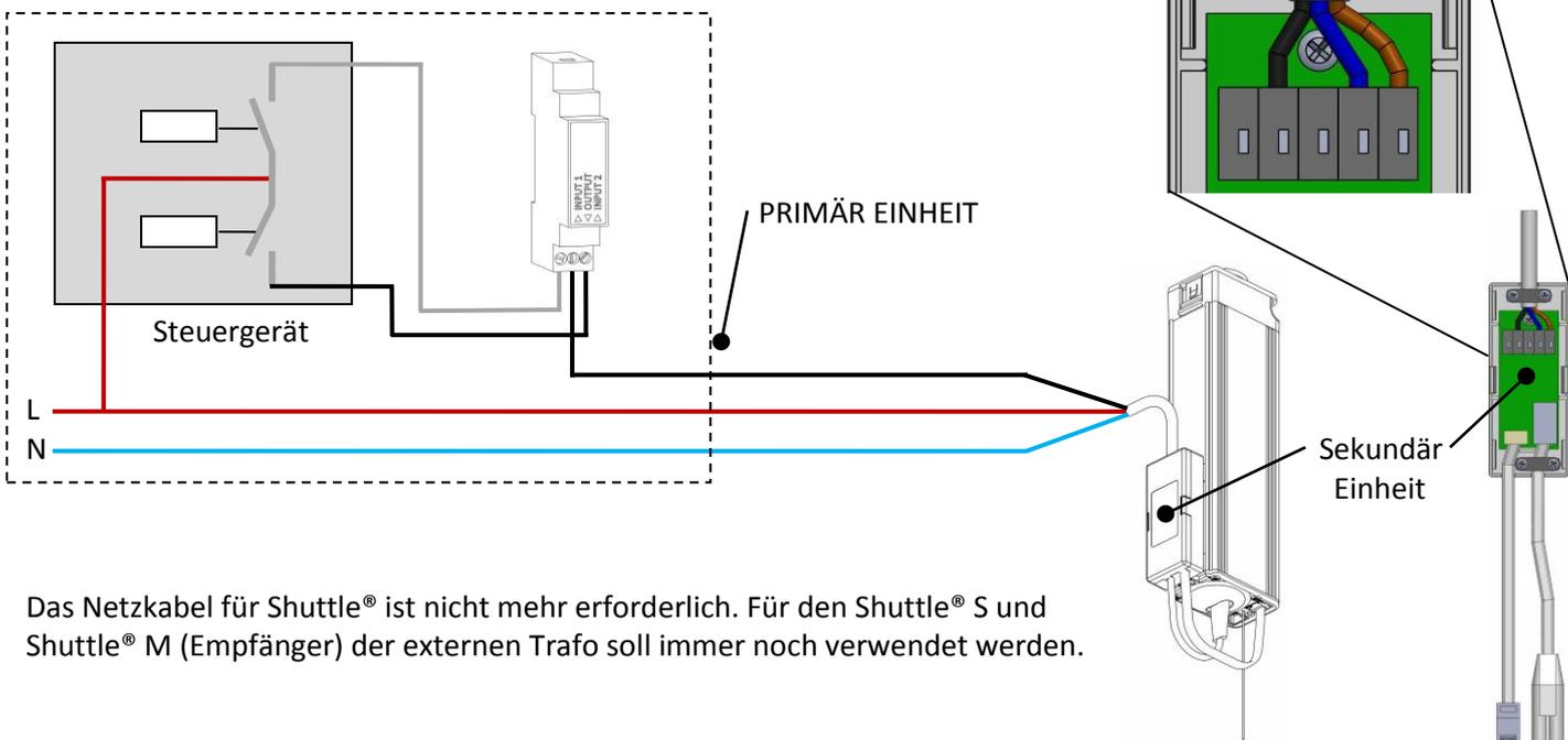
Das Netzkabel für Shuttle® ist nicht mehr erforderlich. Für den Shuttle® S und Shuttle® M (Empfänger) der externen Trafo soll immer noch verwendet werden.
