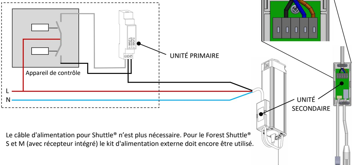
Le câble d'alimentation pour Shuttle® n'est plus nécessaire. Pour le Forest Shuttle® S et M (avec récepteur intégré) le kit d'alimentation externe doit encore être utilisé.
